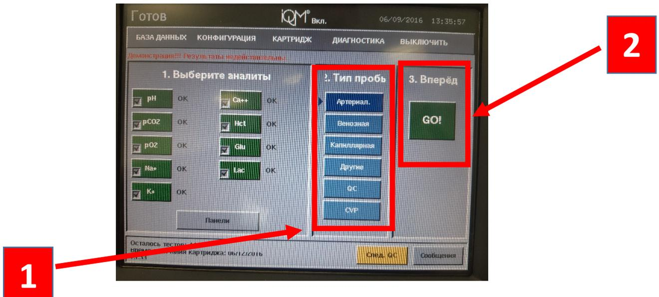
Для проведения анализа поднесите шприц/капилляр к пробозаборной игле и нажмите ОК. Удалите образец после звукового сигнала. Внесите информацию о пациенте (ФИО, температуру, FiO2), если требуется
